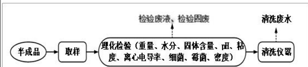
图7 项目实验室流程图
