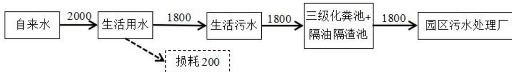
图 1 项目水平衡图（单位：m<sup>3</sup>/a）
